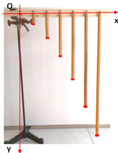
**Figure 12.** – Technique de jalonnement de la parabole décrite par un mobile lancé horizontalement
